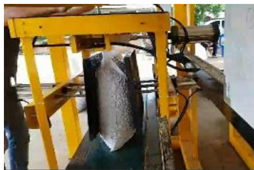
ภาพที่ 9 การทำข้าวโพดหมักแบบบรรจุถุงสุญญากาศ
