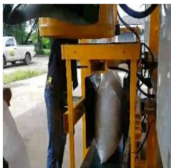
ภาพที่ 9 การทำข้าวโพดหมักแบบบรรจุถุงสุญญากาศ
